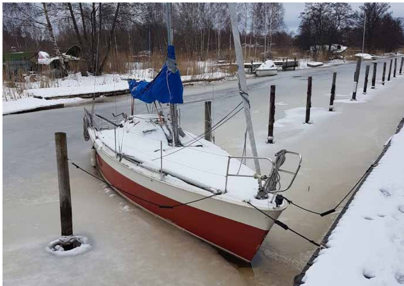
Glöm inte att kolla att presenningarna inte har blåst bort i höst eller under vintern. Smältvatten som rinner in och fryser riskerar att förstöra mycket i båten om du har otur.
