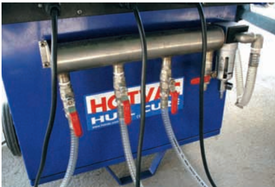
...och fukten sugts ut.
