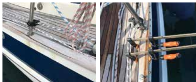
Teaklisten som sprack och mantågstolpsfästet som lossnade när vi träffades av vågen. Teaklisten limmas och skruvas ihop. Skruvhålen pluggas igen med teakplugg.
