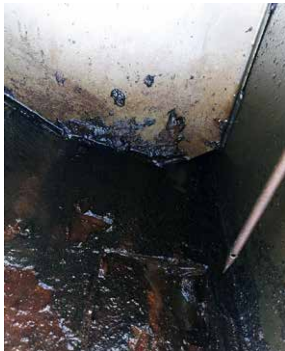
När en motor lyfts ur efter närmare 40 år så kommer det inte se så roligt ut i kölen. Grått och trist. Ny Topcote i hela motorrummet gör att det kommer bli ljus och fint.
