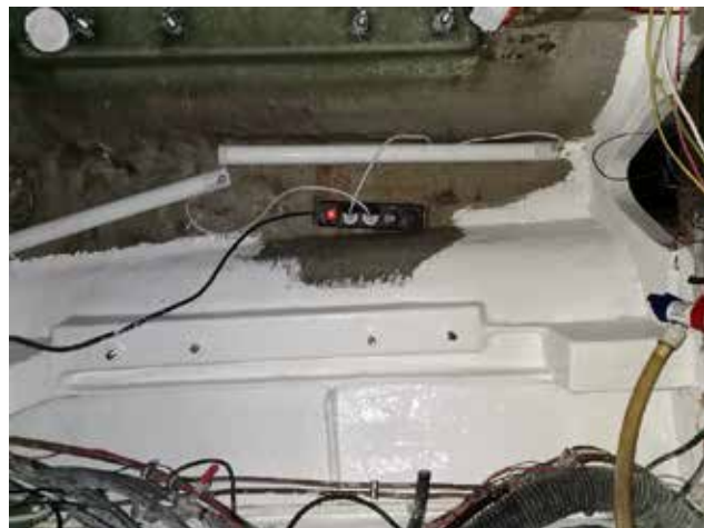
När en motor lyfts ur efter närmare 40 år så kommer det inte se så roligt ut i kölen. Grått och trist. Ny Topcote i hela motorrummet gör att det kommer bli ljus och fint.
