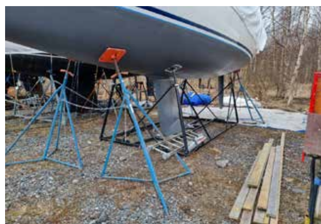
Godkänd uppställning med vagga och två par trefotsstötpor som är sammanbundna tvärs båten.
