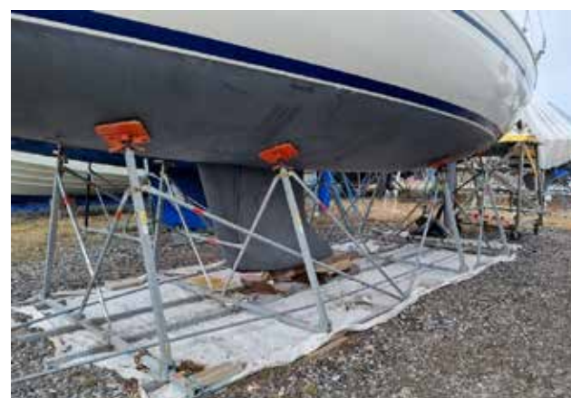
Godkänd uppställning med utbyggd vagga.
