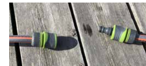
Kopplingen har lossats, så nu är det bara att koppla i pistolhandtaget
