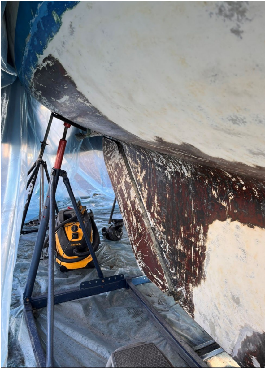
Skrapad båtbottnen, slipning pågår.
