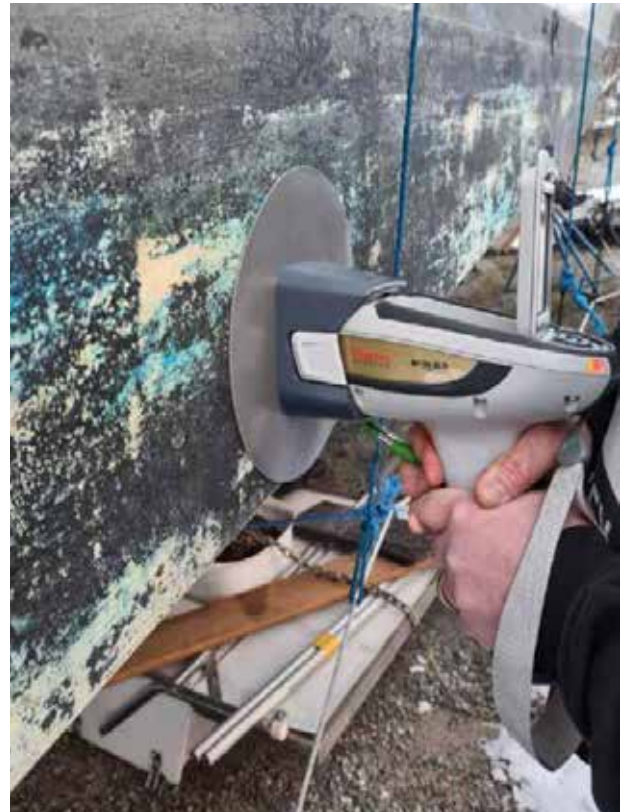
Alltså, detta är ingen slipmaskin utan en "röntgen" som gör XRF-prov. Foto: Carl Rönnow
